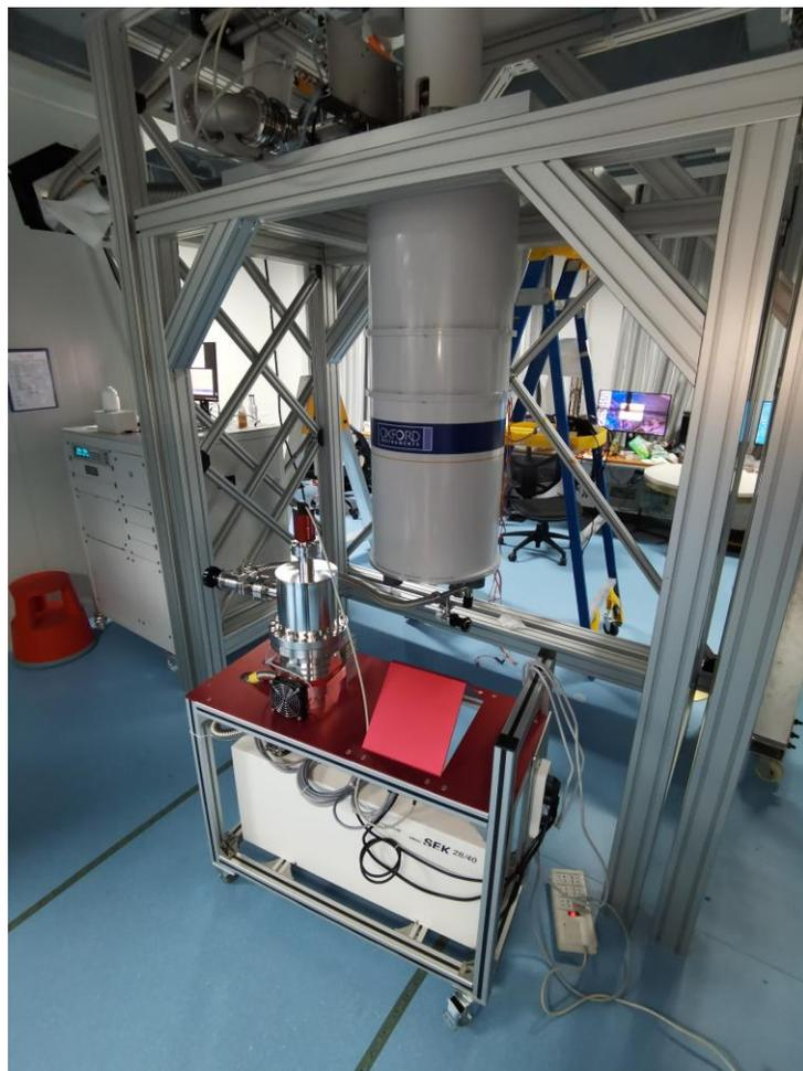
对USTC的低温晶体量热器平台进行振动解耦的设计
